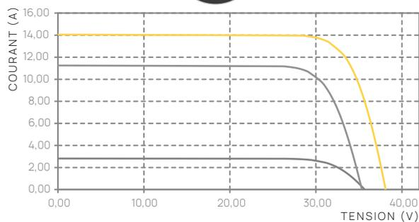
■ 200 W/m<sup>2</sup> et 25°C ■ STC: 1000 W/m<sup>2</sup> / 25°C / AM = 1,5 ■ NMOT: 800 W/m<sup>2</sup> / NMOT / AM = 1,5
